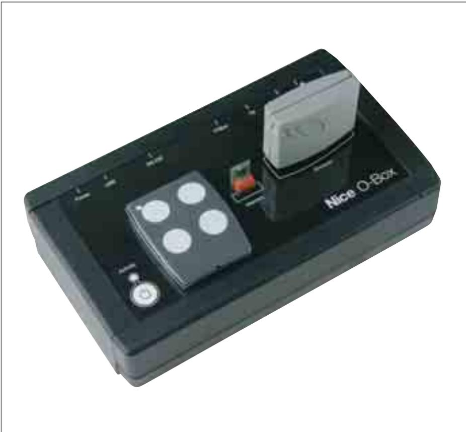
**O-Box è la rivoluzionaria interfaccia di collegamento** che, grazie al software dedicato **“O-Box Software Suite”**, permette di **configurare e programmare direttamente da PC o PDA**, in modo semplice ed intuitivo, **i trasmettitori e i ricevitori della linea One e i dispositivi delle serie Nice Bio, Flo, FloR, Smilo e MORX.**
